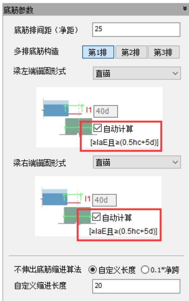
图 5.3-4 梁底筋参数界面
