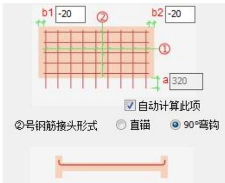
图 5.4-5 阳台板顶筋参数
