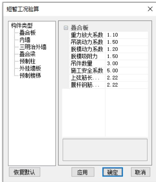
图 6.2-2 短暂工况验算参数设置
