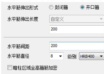
图 5.2-5 水平筋参数设置
