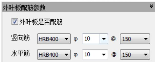
图 5.2-18 墙柱参数设置
