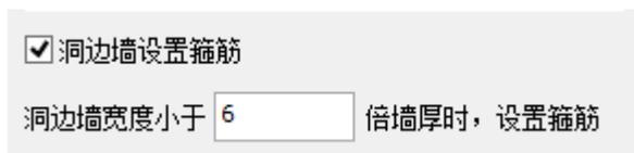
图 5.5-1 墙柱箍筋设置
