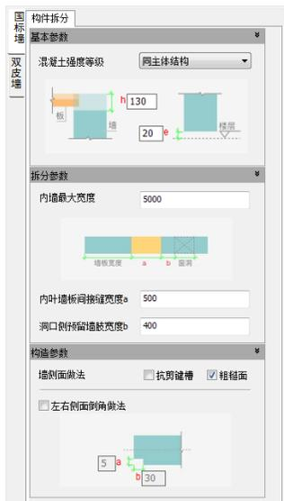
图 3.5-20 国标墙内墙拆分参数
