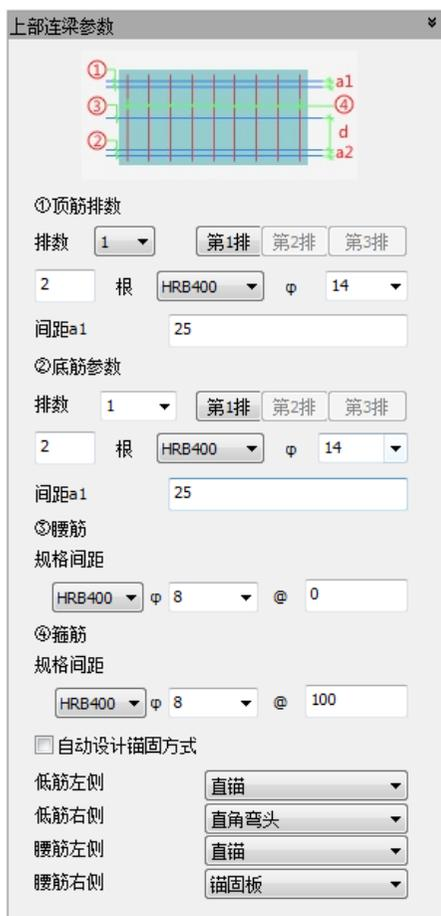
图 5.2-16 双皮墙上部连梁参数
