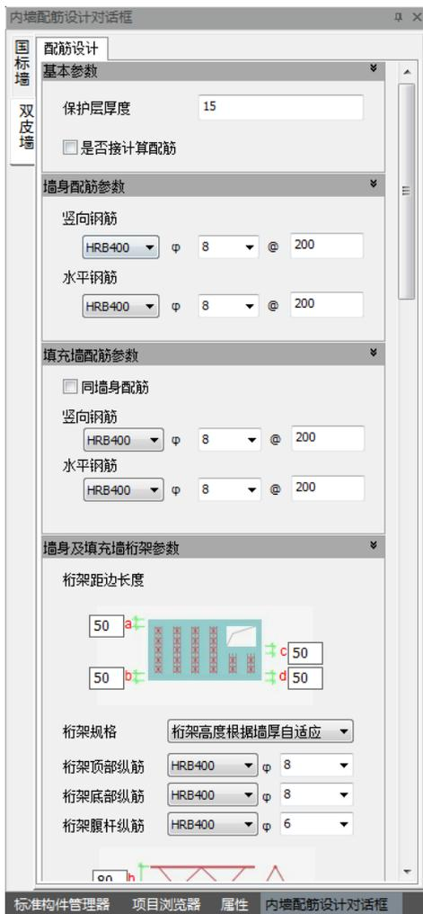
图 5.2-12 双皮墙配筋设计对话框
