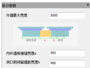
图 3.5-15 国标墙拆分参数
