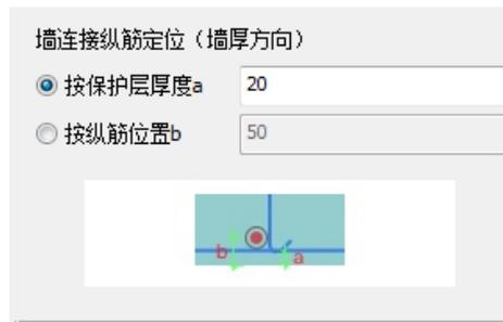
图 5.2-2 墙连接纵筋定位
