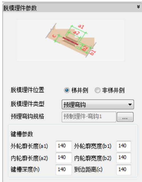
图 5.4-12 脱模埋件参数
