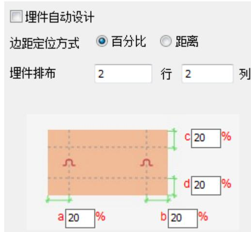
图 5.4-9 阳台板埋件排布参数
