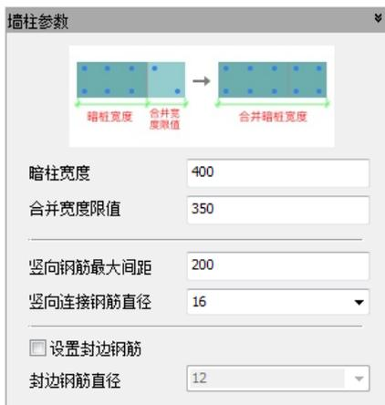
图 5.2-8 墙柱参数设置
