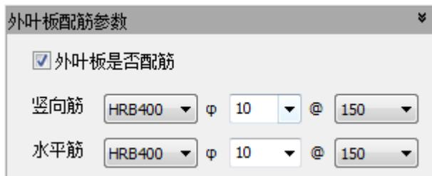
图 5.2-10 墙柱参数设置
