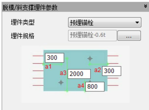
图 5.2-20 墙脱模/斜撑埋件参数
