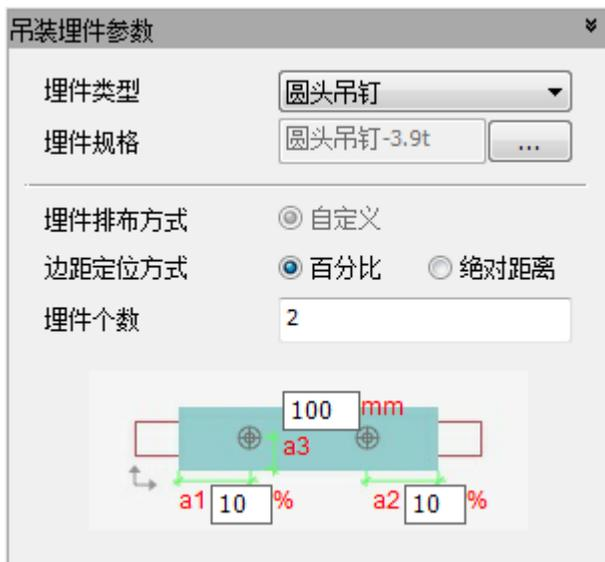
图 5.2-19 墙吊装埋件参数
