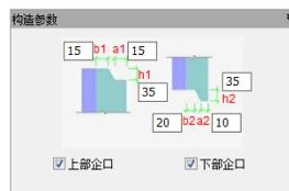
图 3.5-19 双皮墙构造参数
